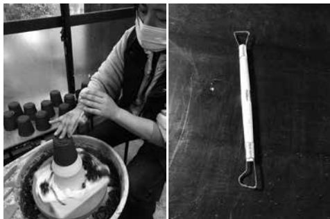
図6 削り作業の風景(左)と使用する道具/カンナ(右)
