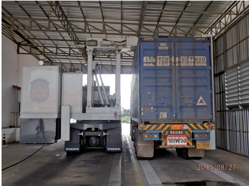
図表 3 通過車両のX線非接触検査（ラオス・サワナケット）
